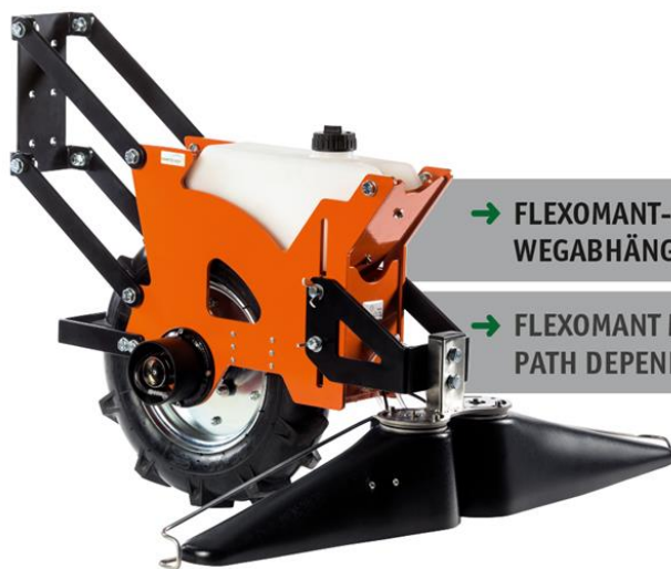
Flexomant mudel ratta jõul töötav pump
